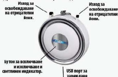
**Зареждане на уреда** Уредът се зарежда с помощта на USB кабел (част от комплекта), който се включва към USB порт на лаптоп/компютър или с използване на адаптер от мобилен телефон или друго устройство. Издържа до 48 часа. При желание може да закупите USB адаптер от Грийн Мастър на цена 3,90 лв (код 20199).
